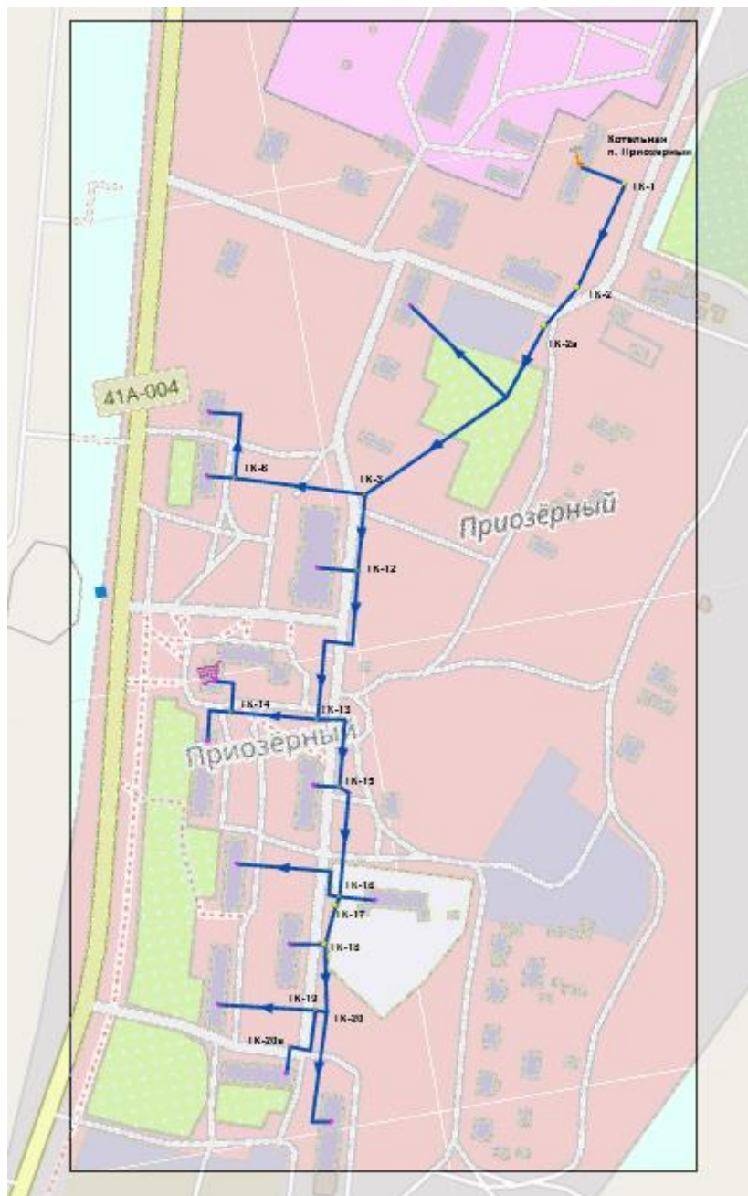
Рисунок 11. Зона действия котельной п. Приозерный
