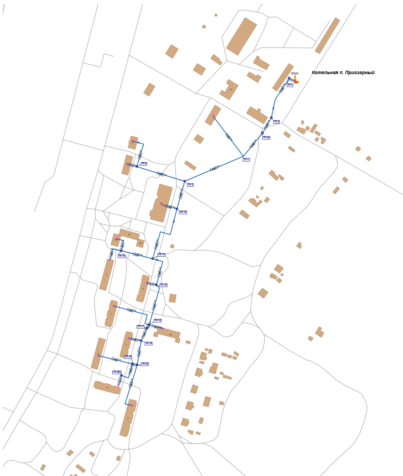
Рисунок 4. Карта-схема тепловых сетей от котельной п. Приозерный ООО «Ресурсосбережение» Ям-Тёсовского сельского поселения
