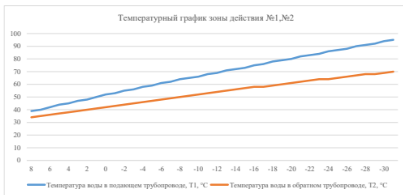
Рисунок 2. Температурный график сетевой воды для котельных ООО «Ресурсосбережение» на отопительный сезон 2024-2025 гг.
